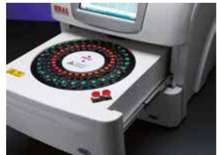
Ротор HB&L с инокулированными флаконами. Тест на скрининг мочи и ОАА
